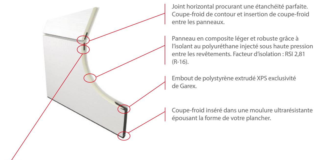
Joint horizontal procurant une étanchéité parfaite. Coupe-froid de contour et insertion de coupe-froid entre les panneaux.
