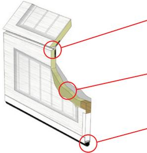
Coupe-froid et joint horizontal procurant une étanchéité parfaite. Aucune circulation d'air entre les panneaux.
